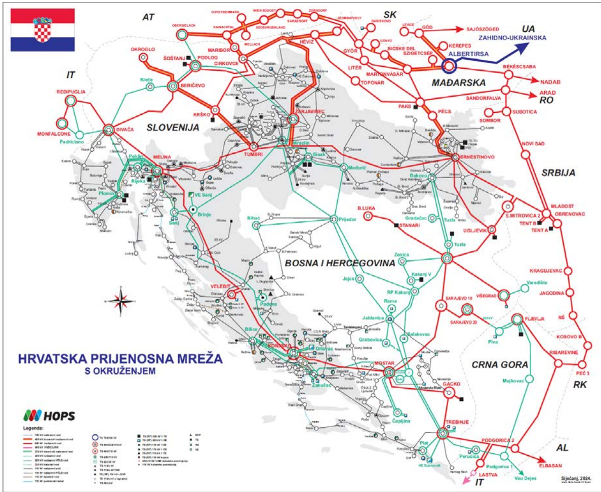
Slika 3. Prijenosna mreža 110-220-400 kV Hrvatske s okruženjem, stanje prosinac 2023. godine
